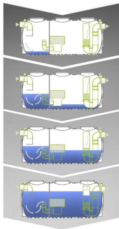
(nível do terreno) seja superior ao nível da linha de água da superfície a drenar. Esta medida irá prevenir que os hidrocarbonetos acumulados na superfície se escapem para o exterior. Regra geral este nível será o nível da sarjeta ou sumidouro mais elevados da rede de drenagem.
