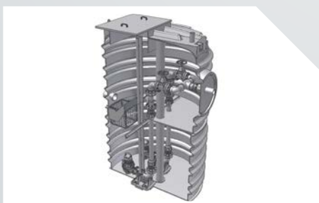
STATION DE RELEVAGES DES EAUX USEES COMPACTES
